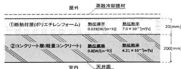
図2 屋根面構造の模式図・仕様
